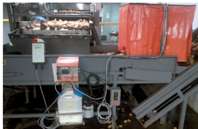
Installation eines MAFEX-Potato/1 Sprühsystems auf einer Verpackungsanlage zur Behandlung mit Keimhemmungsmitteln nach dem Waschen, Trocknen und Sortieren der Kartoffeln.
